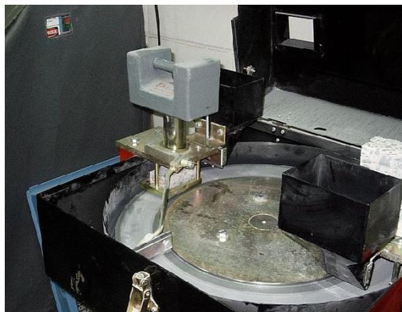
Foto 2. Probetas para ensayo Dorry
